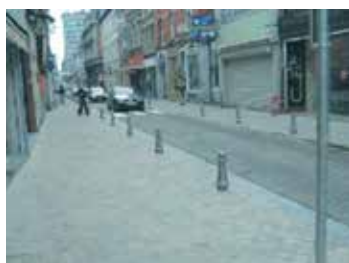
Le trottoir est de plain-pied posant des difficultés pour les déficients visuels ( www.gamah.be )
