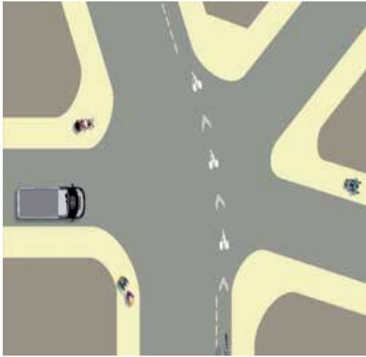
Figure 21 : Matérialisation de la trajectoire cycliste par chevrons + figurines
