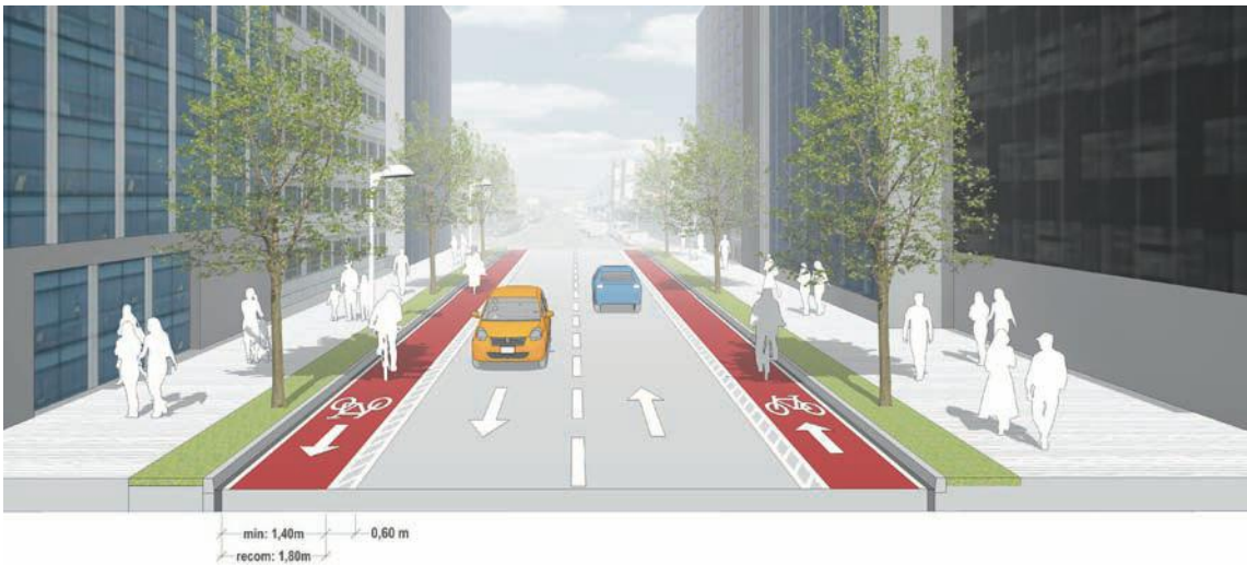
Figura 11. Ejemplo esquemático de ciclocarril
