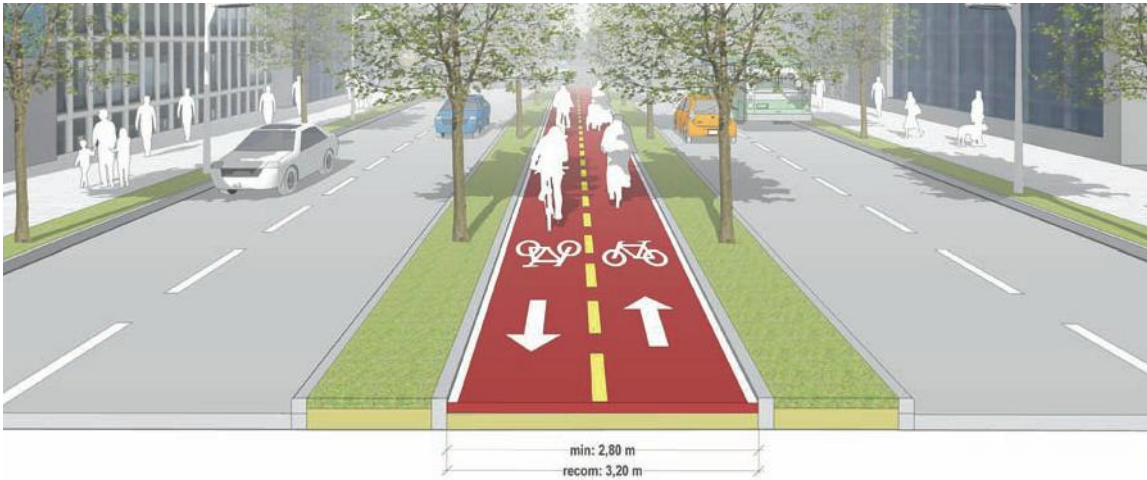
Figura 13. Ejemplo esquemático de ciclovía (bidireccional) en separador central
